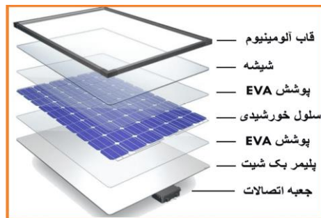
شکل ۲- لایه های مختلف یک ماژول خورشیدی
